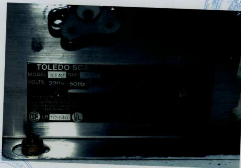
IMAGEN N° 3 (placa de identificación de la báscula de pesaje)
